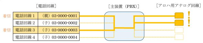
アナログ回線の空き状況を判断し、空いた回線に通電します。
